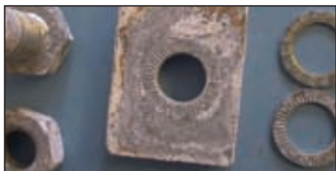
Electro zincado cromado amarillo después de 144 horas
