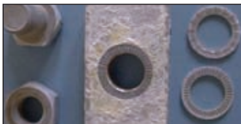
Recubrimiento de zinc después de 144 horas
